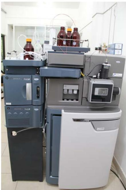
*Espectrómetro de masas de alta resolución.
